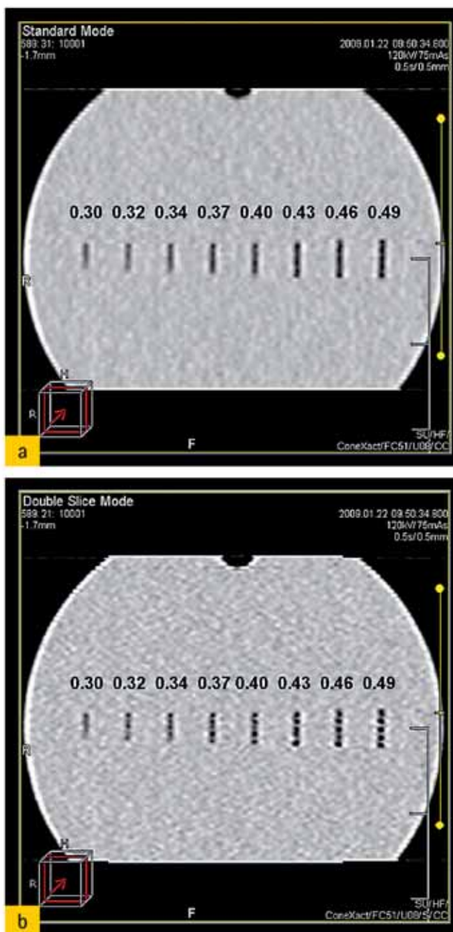
Рис. 2. Корональные изображения тестового фантома с разрешающей способностью 0.32 мм и фильтром FC51 для: а) стандартного режима; в) режима с удвоением количества срезов
